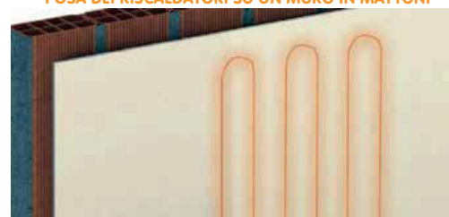
POSA DEI RISCALDATORI CON DOPPIA LASTRA DI CARTONGESSO
