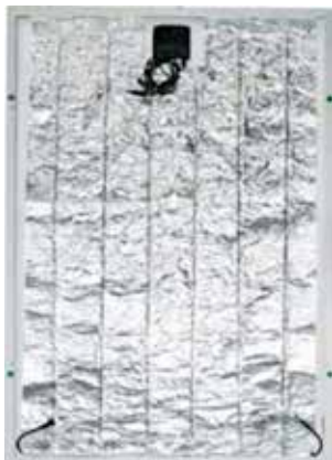
PELLICOLA RISCALDANTE APPLICATA SUL RETRO DI UN PANNELLO FOTOVOLTAICO
