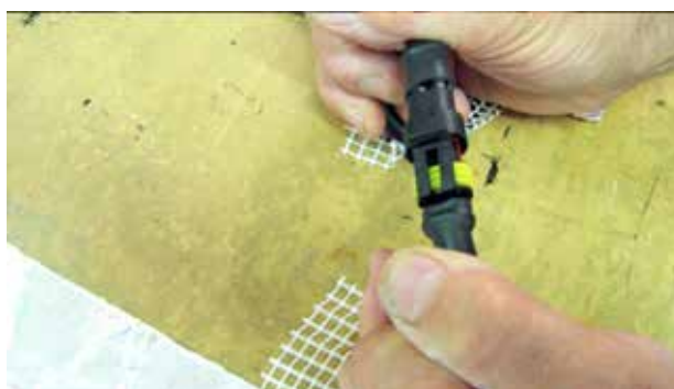
AGGANCIO DI UN CONNETTORE MODULO-MODULO
